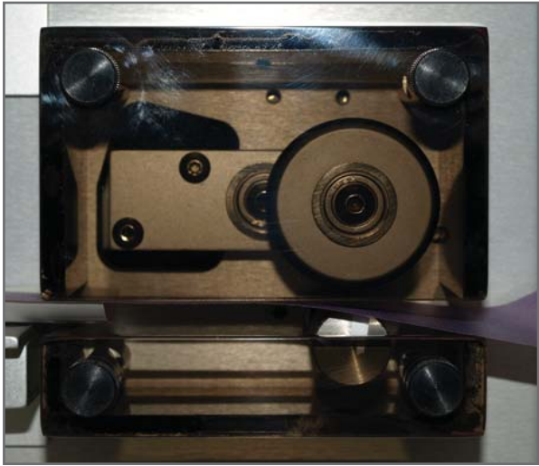
防护驱动绞盘和夹送辊的特写视图
