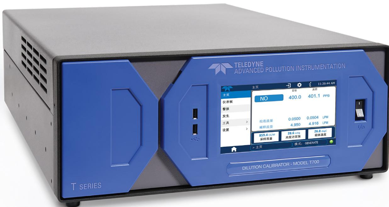
T700使用高精度的质量流量控制器，可用于大范围的气体浓度，并且可安装可选的紫外臭氧发生器、光度计和气相滴定室以提供精准可靠的臭氧校准。
